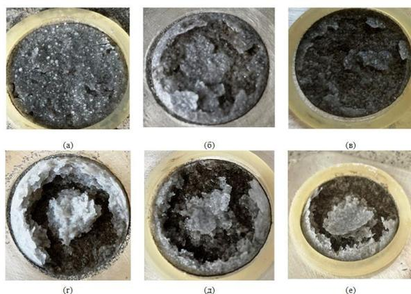
**Рисунок 3.** Фотографии поверхностей анода после разряда до  $70 \text{ C/cm}^2$  (а, б, в) и  $120 \text{ C/cm}^2$  (г, д, е) в разных электролитах. (а), (г) – 15% NaCl без SSA; (б), (д) – 15% NaCl + 0.003 М SSA; (в), (е) – 15% NaCl + 0.012 М SSA.
